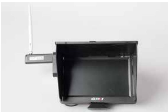
Prototyp eines mobilen tragbaren Monitors mit Empfängereinheit für das Bild der Wärmebildkamera
